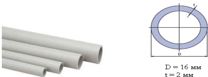
Рис.2 Пластиковые трубки, в которые вводилась исследуемая жидкость.
