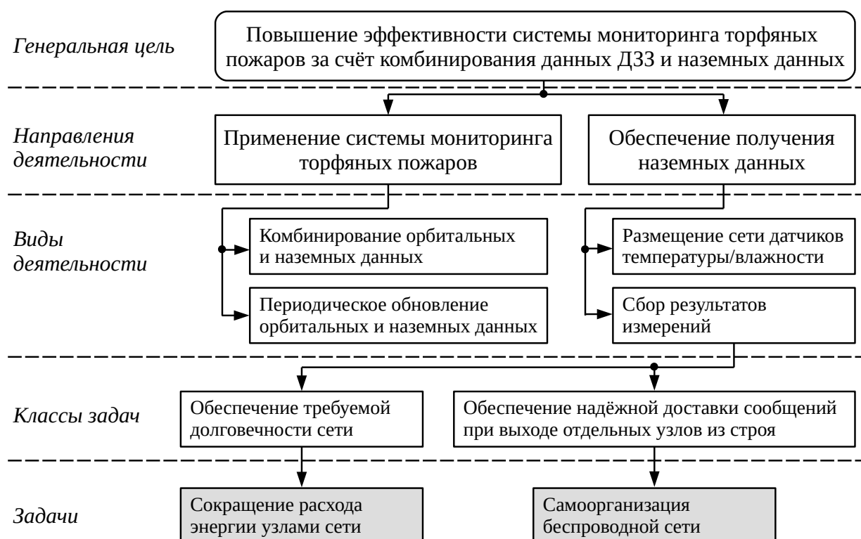
Рис. 1.5. Основные элементы ДЦЗ системы мониторинга торфяных пожаров
