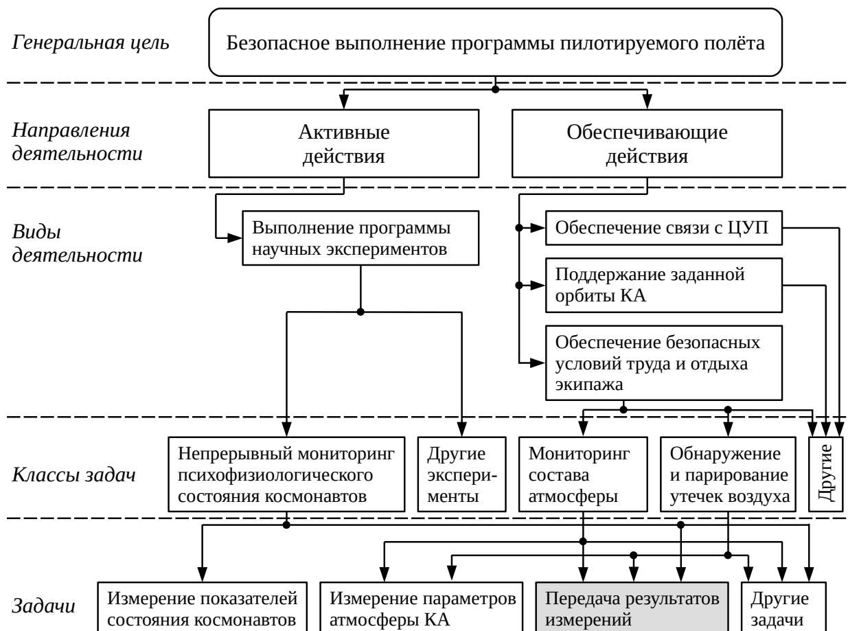
Рис. 1.3. Основные элементы ДЦЗ пилотируемого КА
