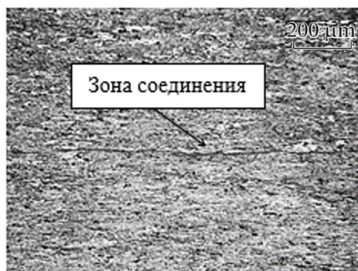
Рисунок 4.11 - Микроструктура зоны соединения заготовок из сплава АМг6 до и после травления (x100) [97]
