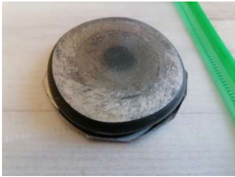
Рисунок 5.10 - Гибридная заготовка из сплавов АМгб – ОТ4-1
