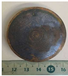
Рисунок 5.10 - Гибридная заготовка из сплавов АМгб – ОТ4-1
