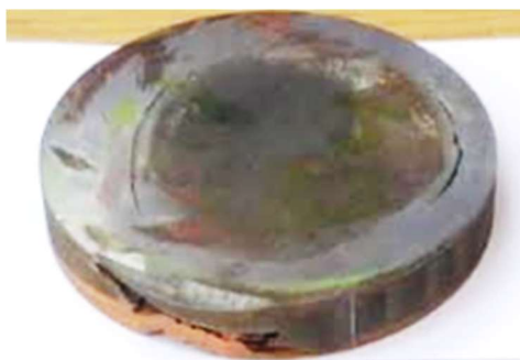
Рисунок 4.15 - Гибридная заготовка, полученная методом осадки с кручением
