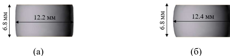
Рисунок 3.4 - Форма образующей при сжатии цилиндрического образца при температуре 20°C: (а) модель материала - формула (2.2); (б) модель материала – формула (2.3)
