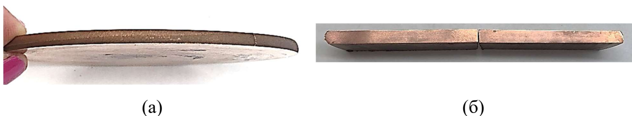
Рисунок 4.12 - Гибридная заготовка из после холодной осадки с кручением: а - внешний вид образца, б – макроструктура поперечного сечения.
