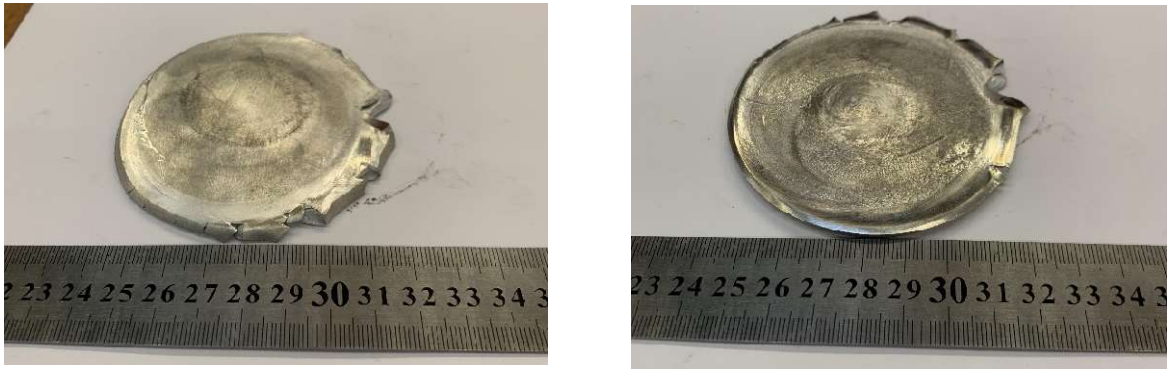
Рисунок 4.7 - Вид сверху (а) и снизу (б) заготовки из сплава АМг6 после осадки с кручением
