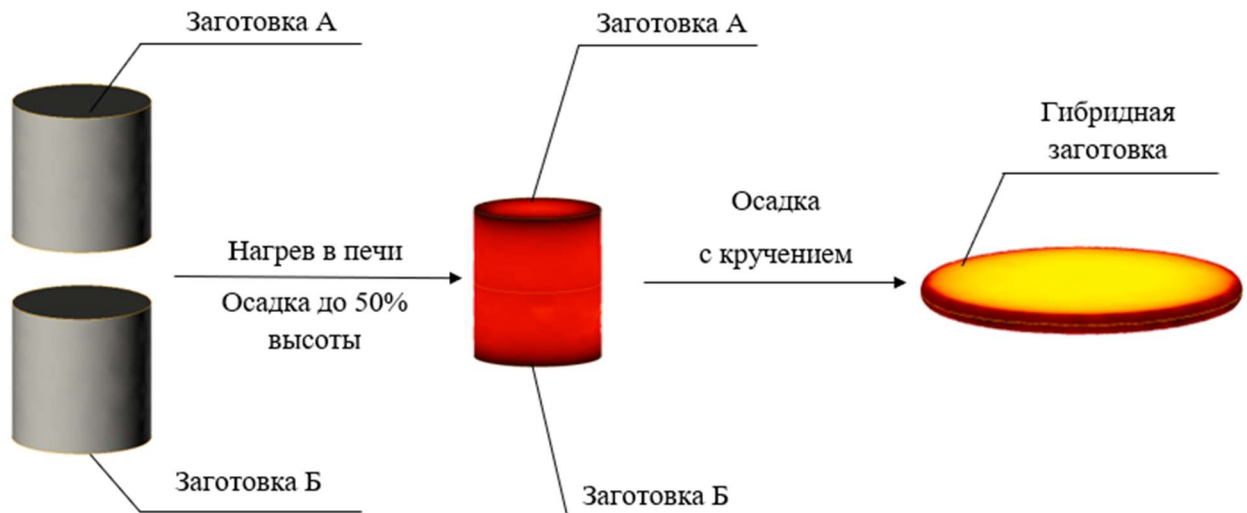
Рисунок 2.6 - Схема осадки образцов из титанового сплава ОТ4-1
