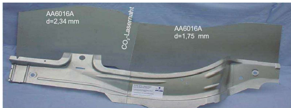
Рисунок 1.3 - Фрагмент корпуса автомобиля, изготовленного из гибридной заготовки (AA6016A - алюминиевый сплав, CO 2 -Lasernaht – сварной лазерный шов)
