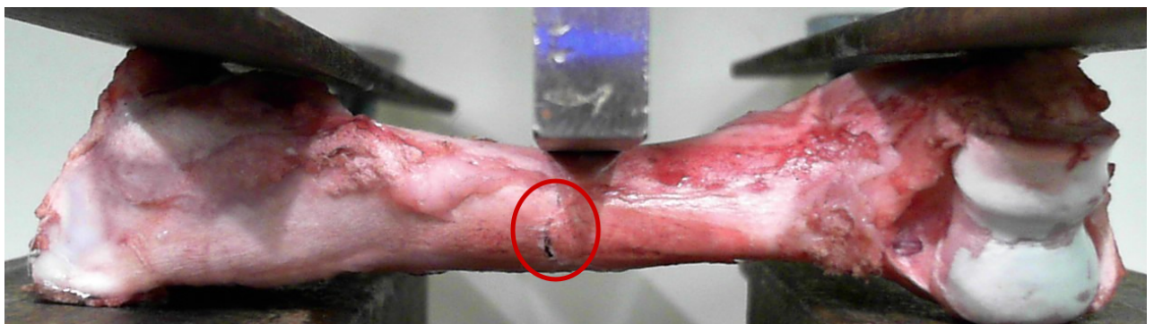
Рисунок 3.37 — Проведение натурального эксперимента, соответствующего поперечному изгибу: образование трещины в области диафиза.
