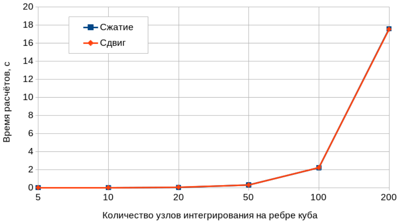
Рисунок 3.6 — Результаты численных расчётов: время вычислений, соответствующее различному количеству узлов интегрирования.
