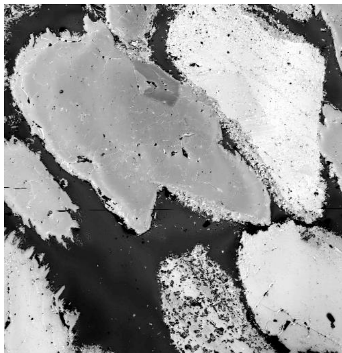
Рисунок 1.5 — Изображение поверхности песчаника, полученное по данным акустической микроскопии (частота – 1 ГГц) [148; 193].
