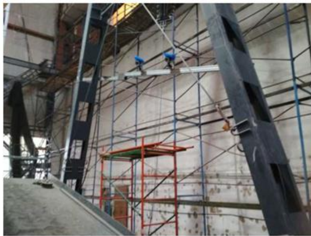
Рисунок 2.4.6 Балка, на которой закрепляются камеры
