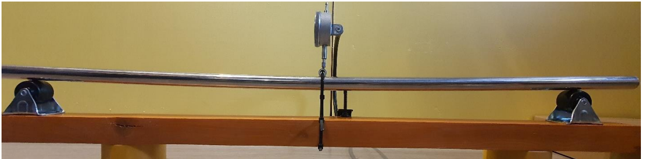
Рисунок 3.3.16 – Экспериментальная установка под нагрузкой. Прогиб 7 мм
