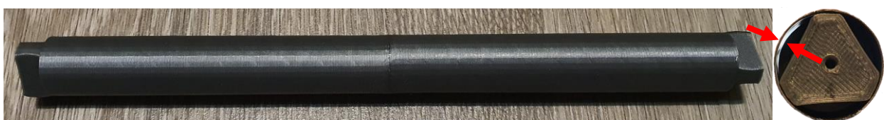
Рисунок 3.3.14 – Габаритный имитатор РС - слева. Имитатор РС, установленный в канале – справа (красным указан зазор между РС и каналом).
