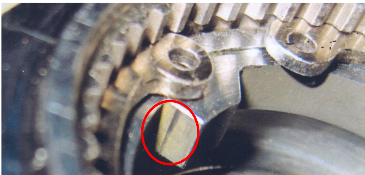
Рисунок 3.2.13 – Ответная поверхность (красным выделена «риска», образовавшаяся после соударения с упором)
