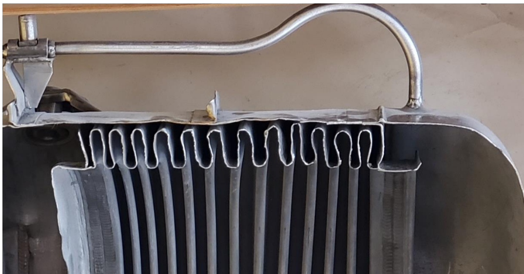
Рисунок 3.4.1 – Пример сифонов КБ установок 1 поколения
