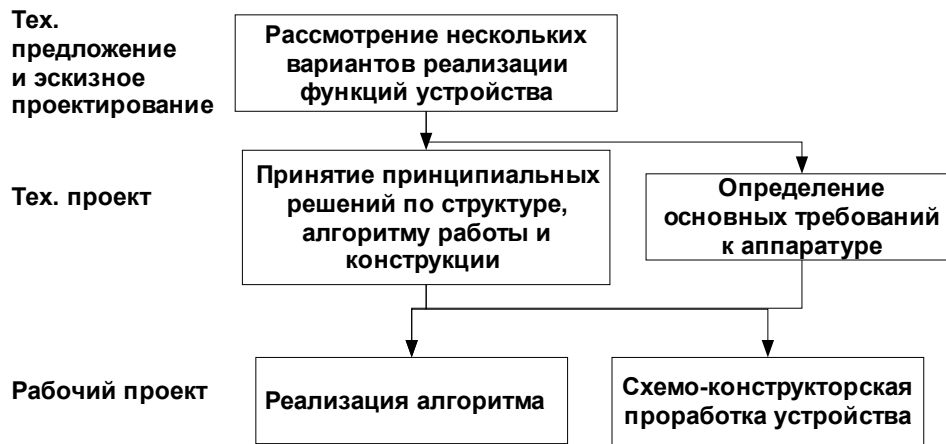
Рисунок 1 Маршрут проектирования ЦУ на ПЛИС
