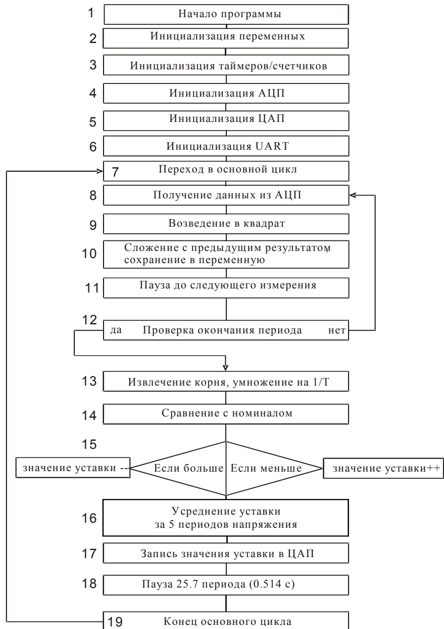
Рис.8. Алгоритм работы управляющей программы микроконтроллера в ЦАОС.
