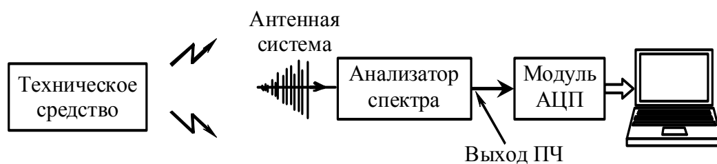
Рис. 6. Схема экспериментального стенда проведения измерений ПЭМИ технических средств
