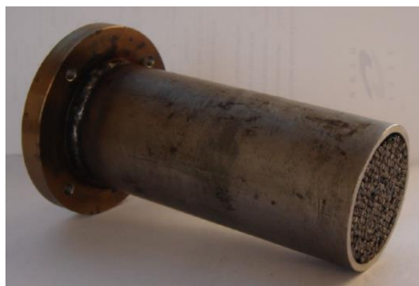
Рисунок 1. Набивной многоканальный катод конструкции НИИ ПМЭ МАИ.
