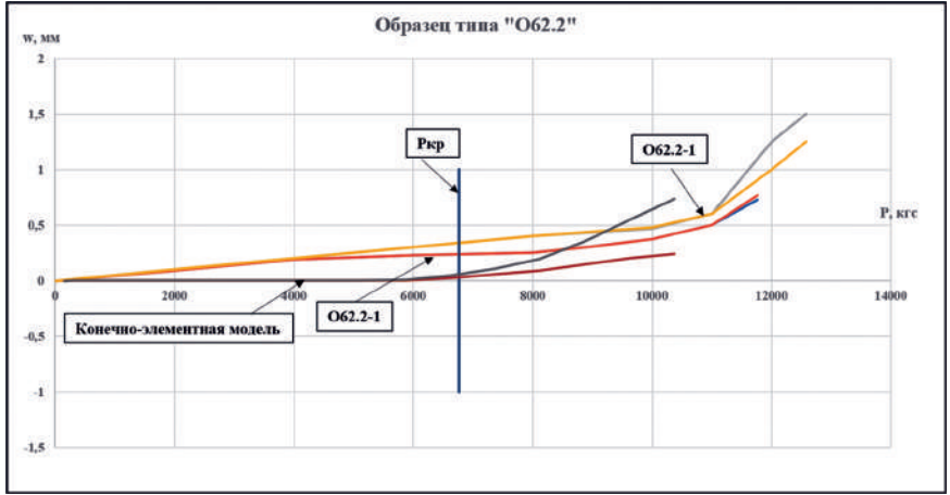
Рис. 13. Перемещения из плоскости точек верхней и нижней поверхностей в центре образцов типа «O62.2», первый этап испытаний
